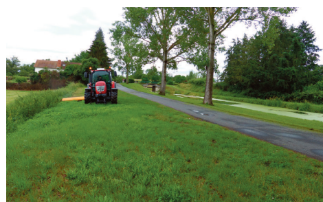
Fauchage des abords du Canal de Berry avec le broyeur d'accotement
